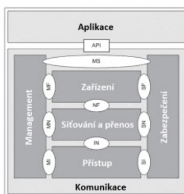
Obrázek 2 normy – Architektura ITS stanice
