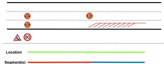
Obrázek 5 – Modelový příklad 9, omezení rychlosti s kontrolou vzdálenosti vozidel (obrázek D.9 normy)
