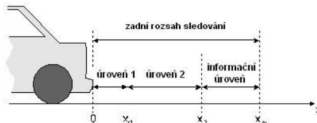
Obrázek 3 – Úrovně varování pro zadní sledovanou oblast
