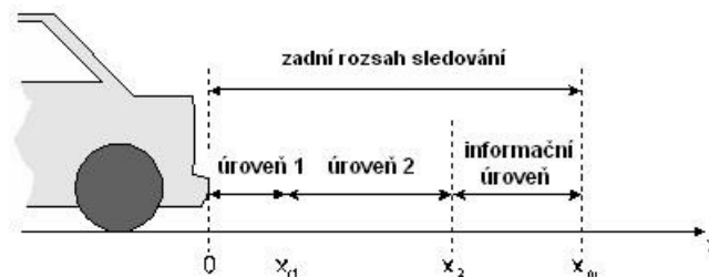
Obrázek 3 – Úrovně varování pro zadní sledovanou oblast
