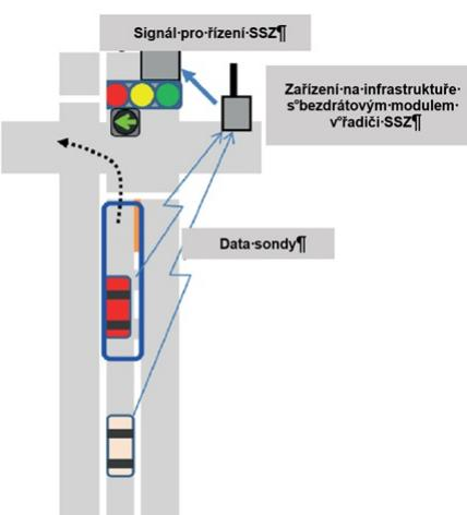
Obrázek 3: Schéma řízení pro levé odbočení (Obr. 3 normy)
