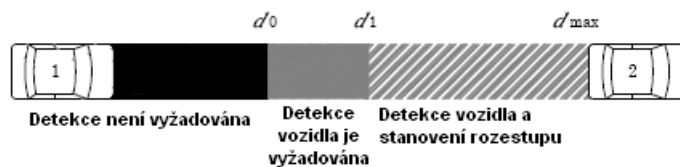
Obrázek 3 – Rozsah detekce (1 – předmětné vozidlo , 2 – cílové vozidlo)
