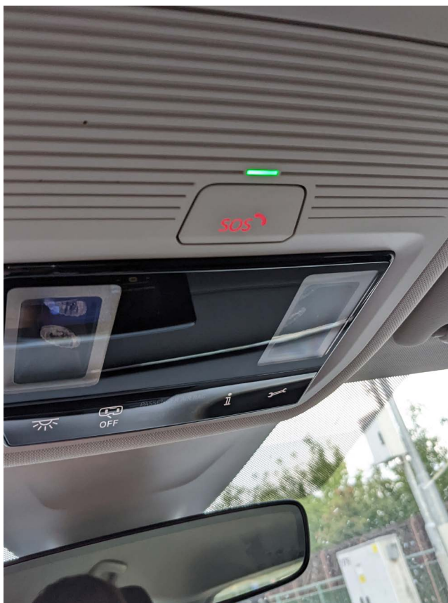
Tlačítko eCall v osobním vozidle
