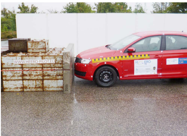
První zkušební CRASHTEST pilotního nasazení systému eCall (projekt HeERO pro MD ČR Ústavem dopravních prostředků FD ČVUT)
